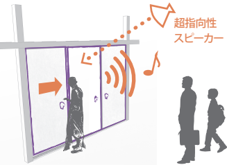
来館者がふすまを動かすと超指向性スピーカーによりふすまから音が流れる。ふすまを閉め切ると、モーションセンサーにより動画が始まる。
