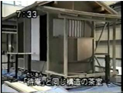
Full-scale model of Myokian Tai-An, Earthquake Impulse Table Experiment Video of the experiment (NHK News) 妙喜庵待庵衝動台実験のための実物大モデル 実験映像 (NHK ニュース)
