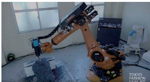
[図2] ロボットアームで布ロールを削っている様子 図版提供：noiz
